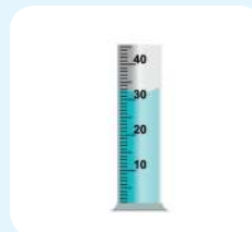
Alat ukur: gelas ukur Hasil pengukuran: 32 mL
